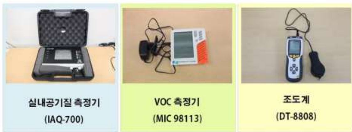
[사진 4.5.1-1] 실내공기질 측정기, VOC 측정기, 조도계
